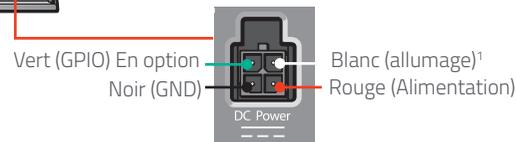
1. Pour faire fonctionner le routeur, le fil blanc doit être connecté à 9-36 VDC.
